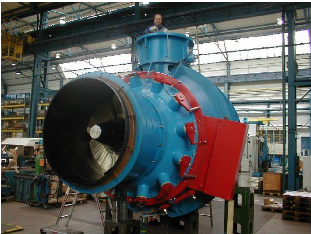
Abb. 26. Kaplan-Turbine bei Herstellung.
