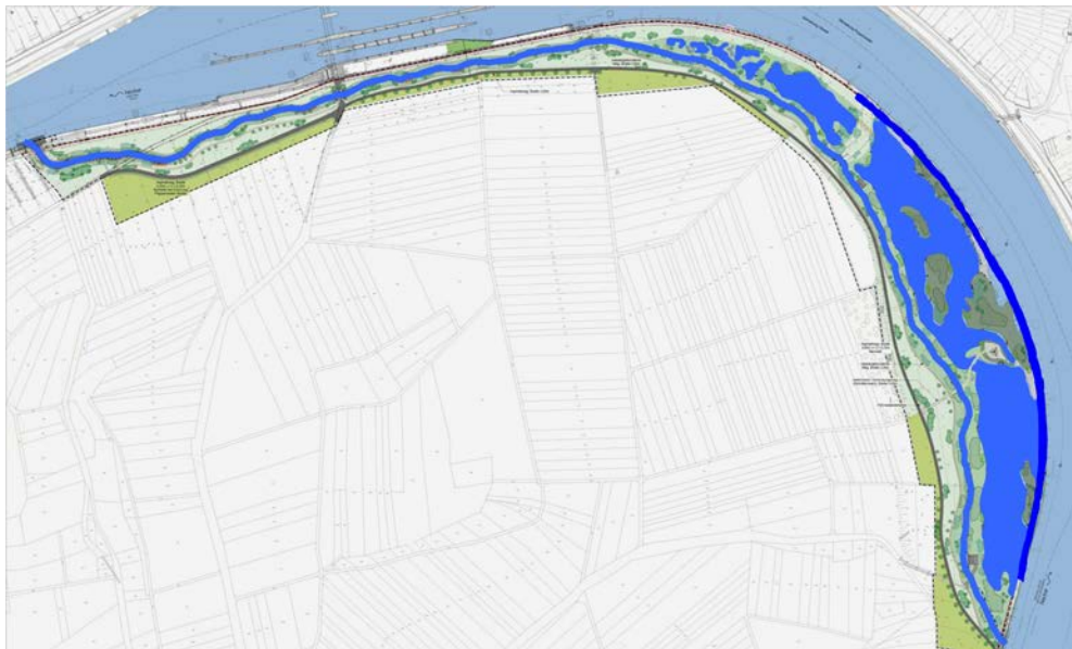
Abb. 27: Projektplan mit dem markierten, rückzubauenden Uferdamm. Durch dessen Entfernung entstand eine Stillgewässerfläche von ca. 3,8 ha entstehen.
